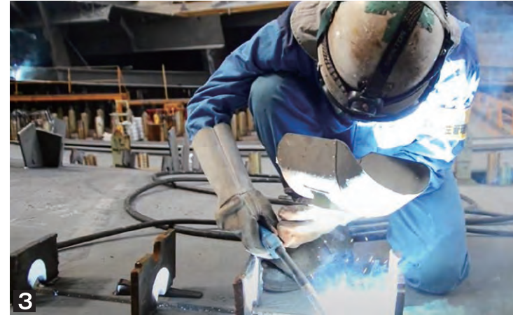
1 業界屈指の大型造船所 2 町の子供たちと出港のお見送り 3 部材を溶接し、巨大ブロックを製作します。
