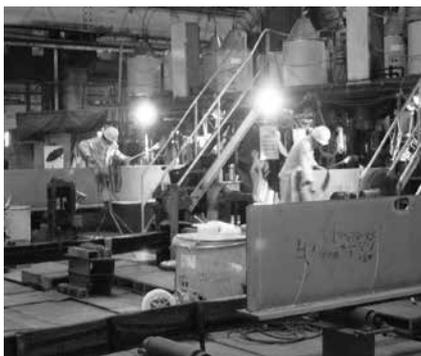
▲ビルドアップロンジ自動溶接装置
