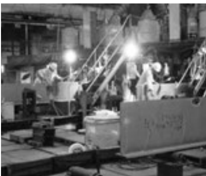
▲ビルドアップロンジ自動溶接装置
