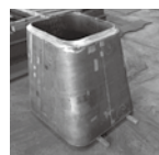
鉄骨工場向けコラム開先加工
