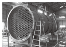
焼却炉丸型冷却塔
