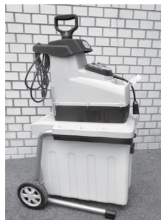
▲電動式で直径約3センチまでの枝を粉碎できます。重量26キ口、軽自動車でも運搬できる大きさです。
