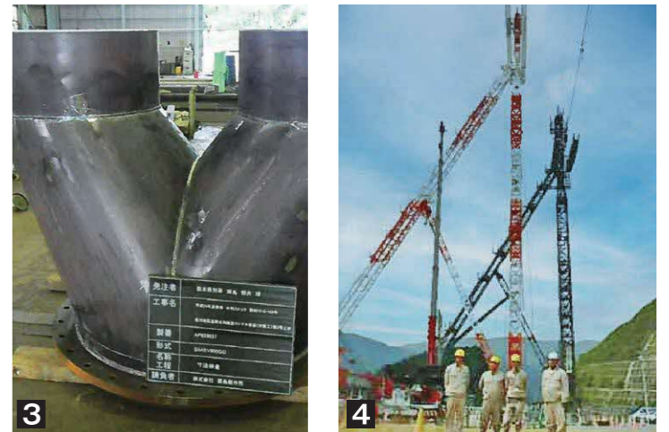
1 玉名工場の得意とする大型配管 2 3 玉名工場では配管と製缶、2つの加工エリアで船舶海洋製品を中心とした製品が作られています 4 鋼材ヤードでつくられた大型構造物
