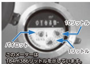
わずかでも水道メーターのパイロットマークが回っていれば、漏水の可能性があるので、早急に長洲町水道工事指定店に修理を
