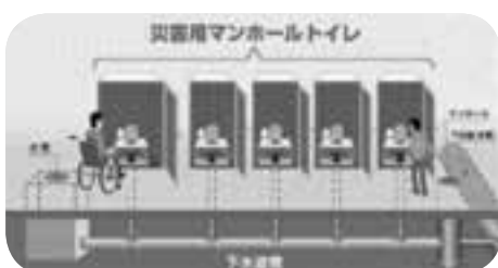
災害時、便利なマンホールトイレ
